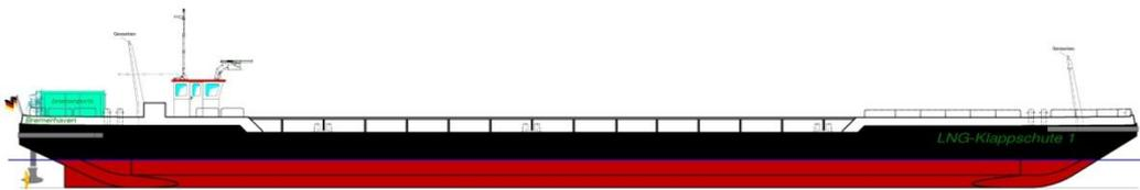
Figure 4: LNG-Klappschute für bremenports
